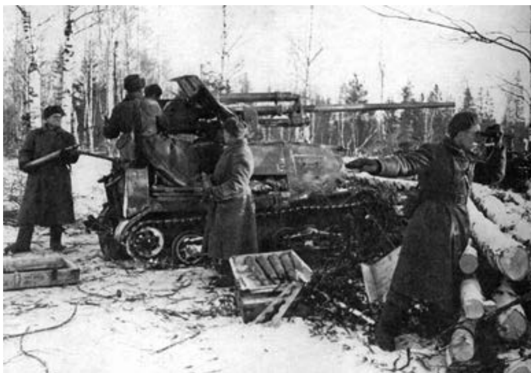
САУ ЗиС-30 (57-мм противотанковое орудие ЗиС-2 на базе артиллерийского тягача А-20 «Комсомолец») на огневой позиции
