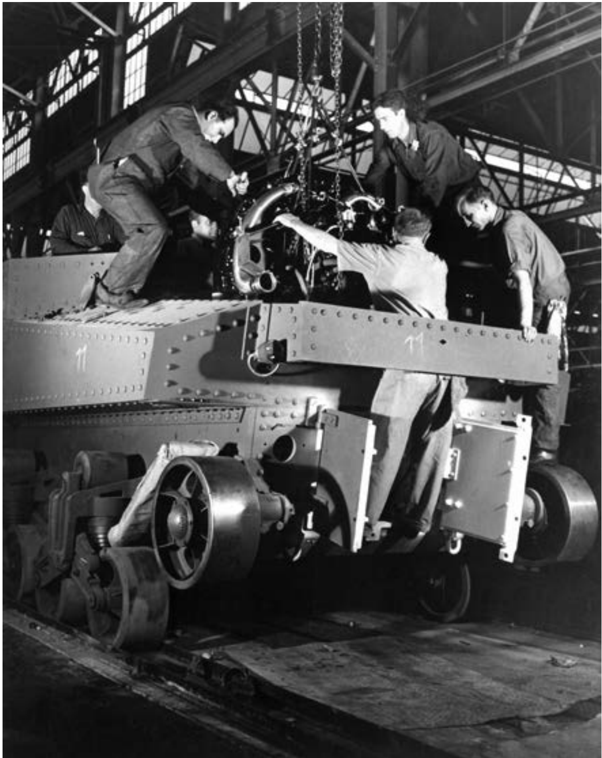
Рабочие американского завода устанавливают двигатель в танк М3
