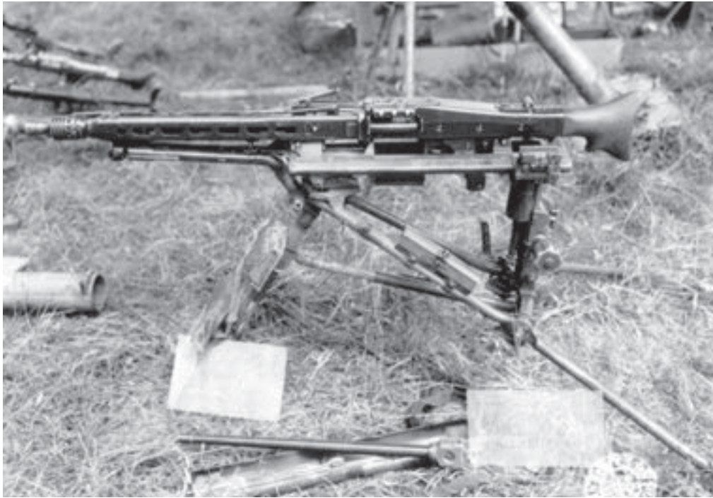
Немецкий 7,92-мм пулемет MG-42 на станке
