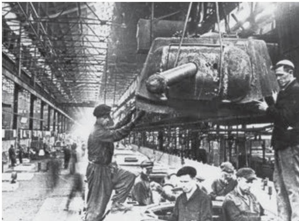
Монтаж башни танка на заводе им. Кирова
