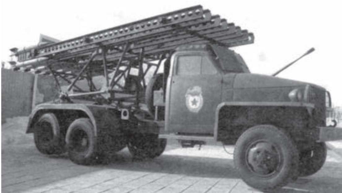
Реактивная артиллерийская установка БМ-13 на шасси грузового автомобиля «Студебеккер»
