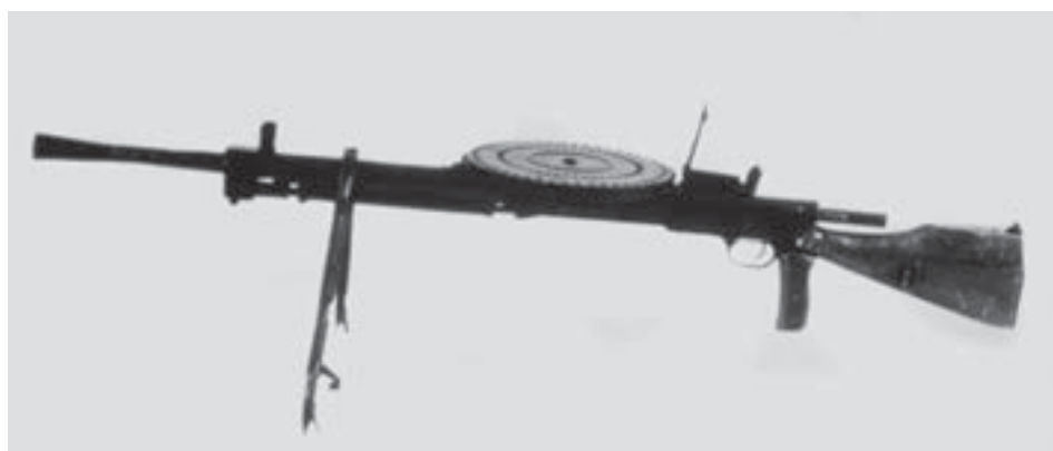
7,62-мм ручной пулемет ДП («Дегтярев пехотный»)
