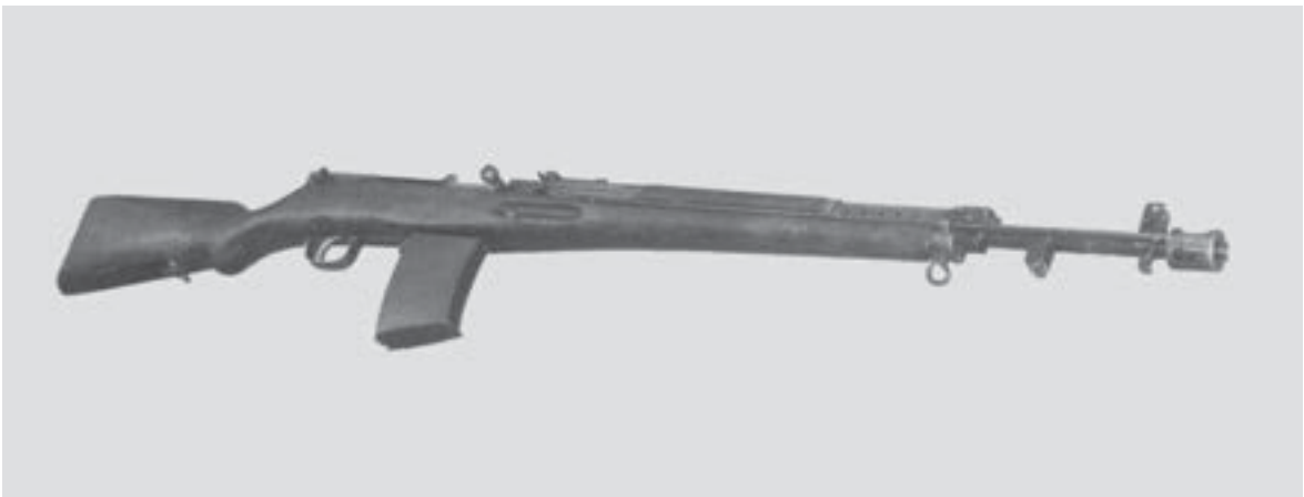
7,62-мм пятнадцатизарядная автоматическая винтовка конструкции С. Г. Симонова (АСВ-36)
