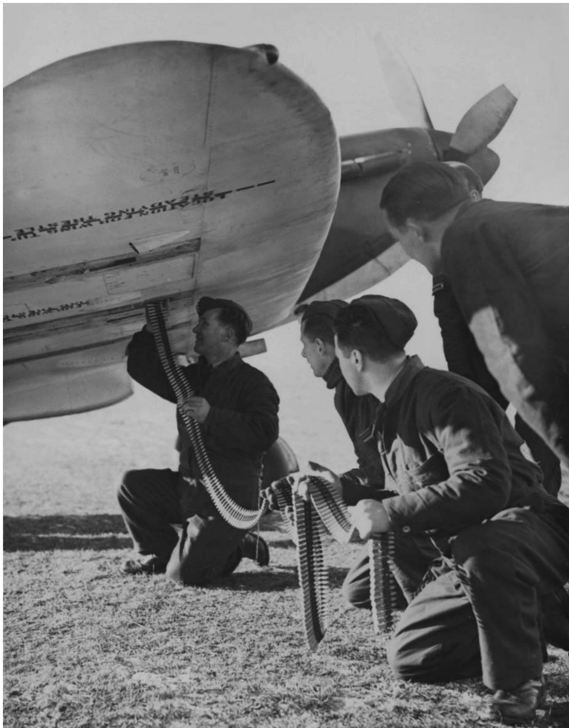
Зарядка крыльевых пулеметов британского истребителя «Спитфайр»
