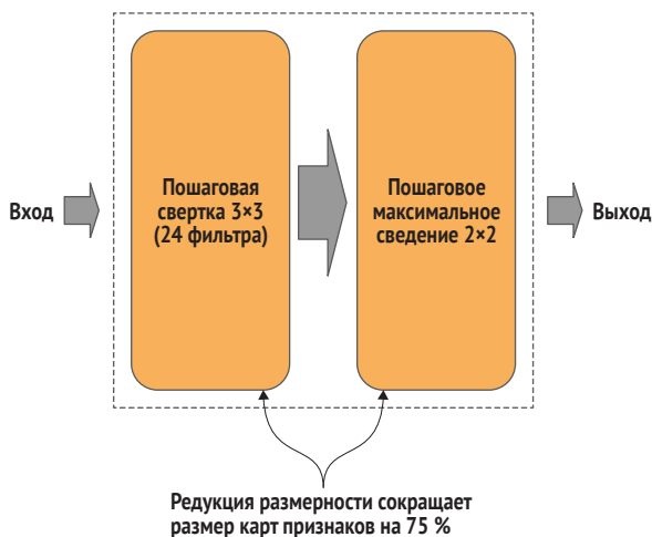
Рис. 8.24 Стержневая группа модели ShuffleNet комбинирует сведение признаков и максимальное сведение для сокращения выходных карт признаков до 6 % от размера входных данных
